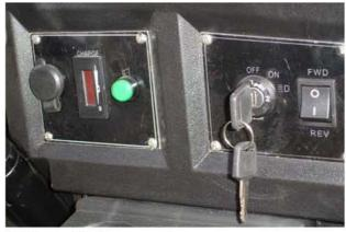
**DIRECTIONAL TOGGLE SWITCH:** Up (**0**) for <u>forward</u> - **Down** (**I**) for <u>reverse</u>.
